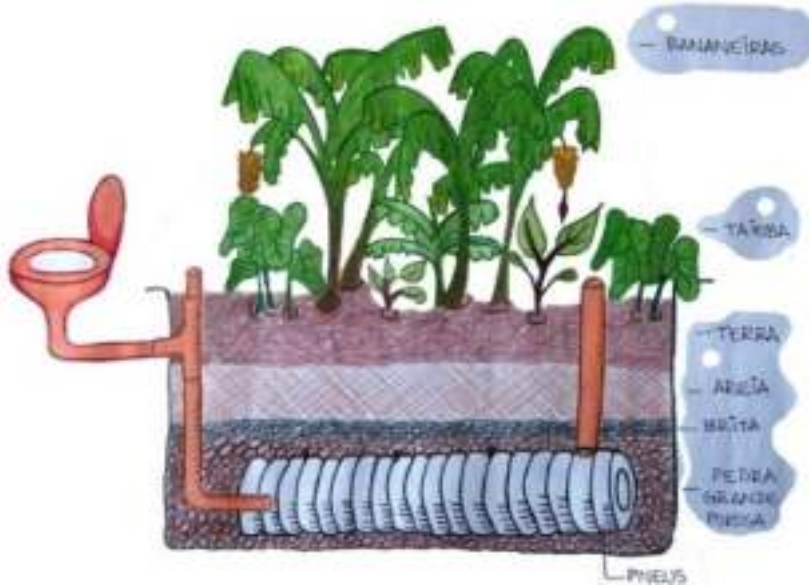
Figura 13 - Esquema de tratamento do tanque de evapotranspiração
